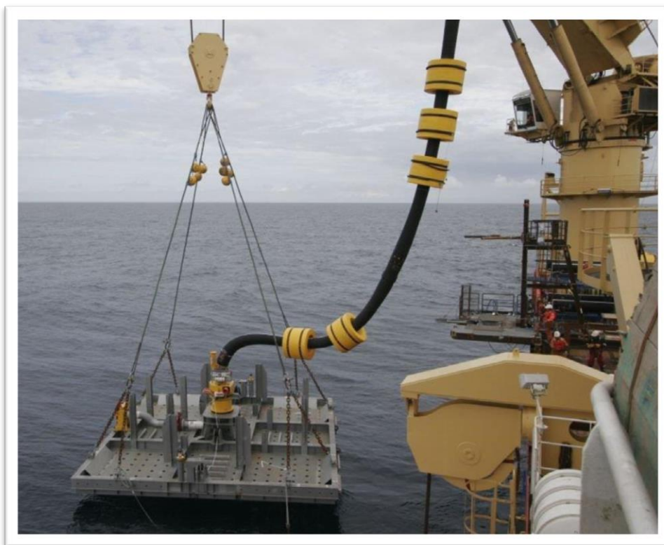
Figur 2-6. Lossesystemet ved installering.
