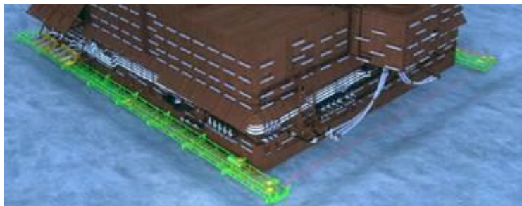
Figur 2-10. Skisse av kutteutstyr (rammer på hver side med kuttebånd imellom) dersom hele tanken skal kuttes av ved basis. Se alternativ C, over.
